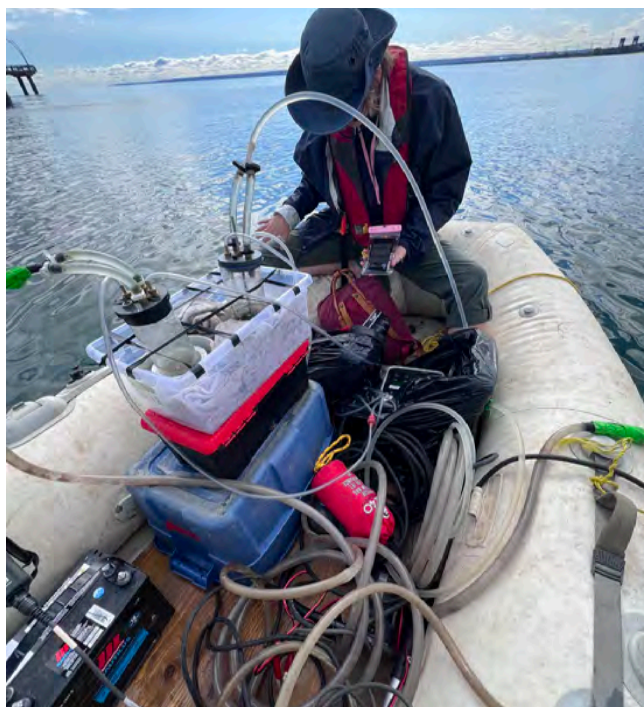
Une équipe de scientifiques d'ECCC, ainsi que de professeurs et d'étudiants de l'Université Western, utilise des détecteurs de radon avec des échantillons d'eau lacustre en zone littorale pour cartographier les zones où les eaux souterraines se déversent le long de la rive nord du lac Ontario. Source : Kayla Bruce, ECCC.
