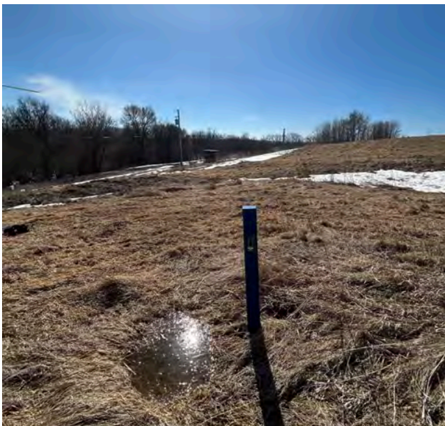
Puits de surveillance à la limite d'un site d'enfouissement historique en Ontario qui a été échantillonné pour détecter la présence de divers nouveaux contaminants, y compris des substances perfluoroalkylées et polyfluoroalkylées (SPFA). Source : James Roy, ECCC.
