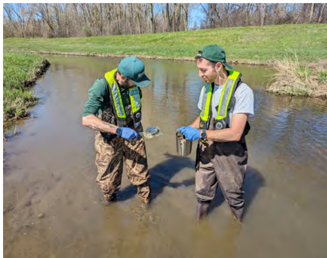
Des scientifiques recueillent des sédiments de fond à l'aide d'une carotte manuelle spéciale. Source : Luke Loken, U.S. Geological Survey.
