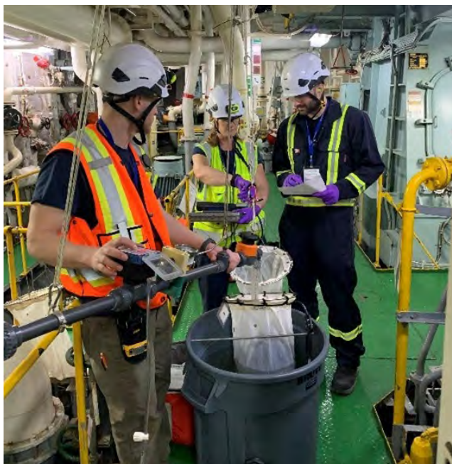
Des chercheurs de Pêches et Océans Canada prélèvent un échantillon d'eau de ballast pour un projet qui examine l'efficacité d'une technologie de traitement des eaux de ballast. Source : Pêches et Océans Canada.
