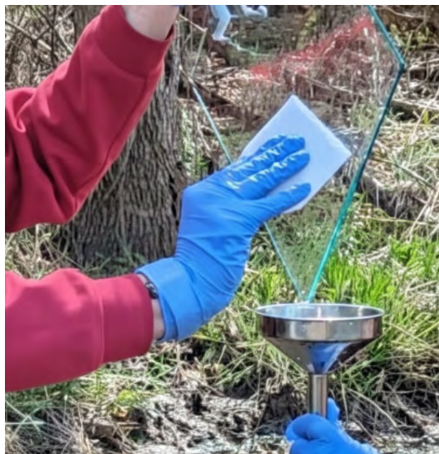
Méthode personnalisée de collecte de l'eau de la microcouche de surface des cours d'eau pour l'analyse de la répartition des SPFA dans les écosystèmes des cours d'eau. Source : Luke Loken, U.S. Geological Survey.
