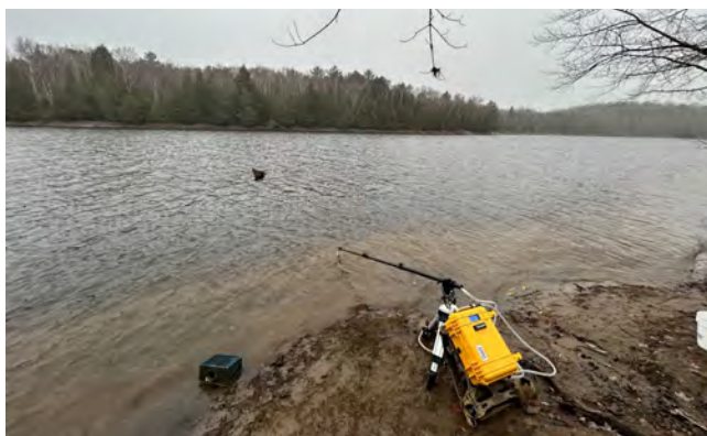
Un sac à dos échantillonneur d'ADNe est utilisé pour prélever de l'eau dans le cadre d'un partenariat entre le MPO et la Première Nation de Mississauga aux fins de surveillance de la carpe de roseau. Source : MPO.
