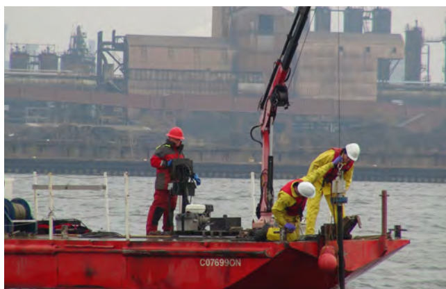
Employés d'ECCC travaillant à bord du NGCC GOOSE III qui effectuent un échantillonnage par carottage vibratoire près du projet d'assainissement du récif Randle, dans le secteur préoccupant du port de Hamilton. Source : ECCC/Section du soutien à la recherche
