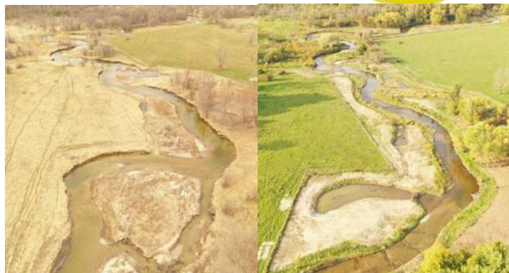
Photos avant et après la stabilisation des berges, la restauration de la rivière et le réaligement du chenal dans la rivière Nottawasaga. Source : Office de protection de la nature de la vallée Nottawasaga.
