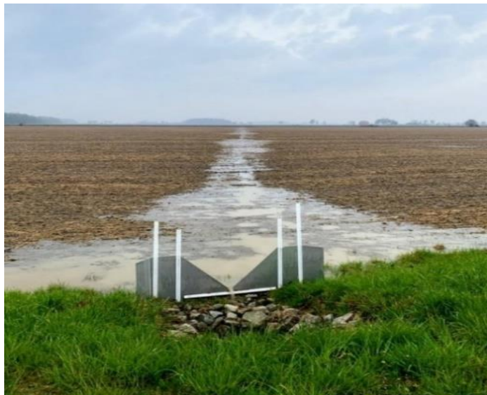
Un déversoir utilisé sur les lieux du projet ONFARM pour recueillir l'eau de surface et calculer son volume durant les épisodes de ruissellement extrêmes (Photo : Association d'amélioration des sols et des récoltes de l'Ontario).
