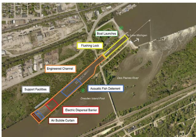
Diagramme du plan structural recommandé pour le projet interbassins du chemin Brandon, à l'écluse et au barrage du chemin Brandon sur la voie navigable de l'Illinois près de Joliet, en Illinois. Source : USACE.
