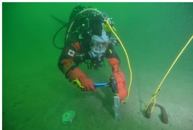
Scientifique installant un dispositif d'échantillonnage pour extraire des échantillons d'eau de la couche protectrice de sable qui isole les sédiments contaminés au fond du SP du havre Peninsula. Source : équipe de plongée de la Direction des sciences et de la technologie de l'eau, Environnement et Changement climatique Canada.
