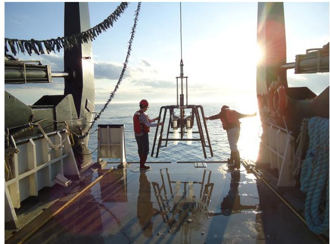
À bord du navire de recherche Lake Guardian de l'USEPA, des scientifiques déploient un carottier multiple en vue d'un prélèvement de sédiments dans le lac Supérieur, dans le cadre du programme de surveillance des sédiments dans les Grands Lacs. Source : Margaret Corcoran
