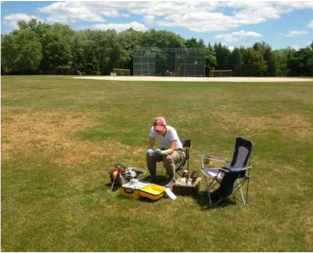
Échantillonnage d'un puits de surface afin de déterminer si les eaux souterraines sont contaminées par le lixiviat d'un site d'enfouissement historique (sous un terrain de baseball). Source : James Roy, ECCC
