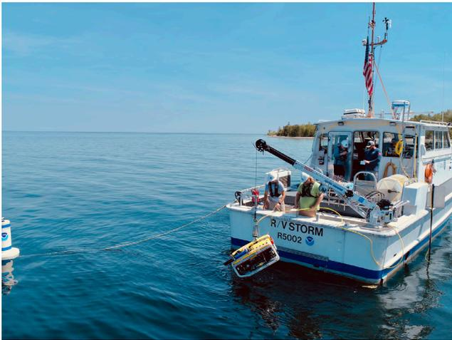
Des ingénieurs du GLERL de la NOAA déploient un véhicule télécommandé pour installer des débitmètres dans le gouffre de l'île Middle, dans le lac Huron.
