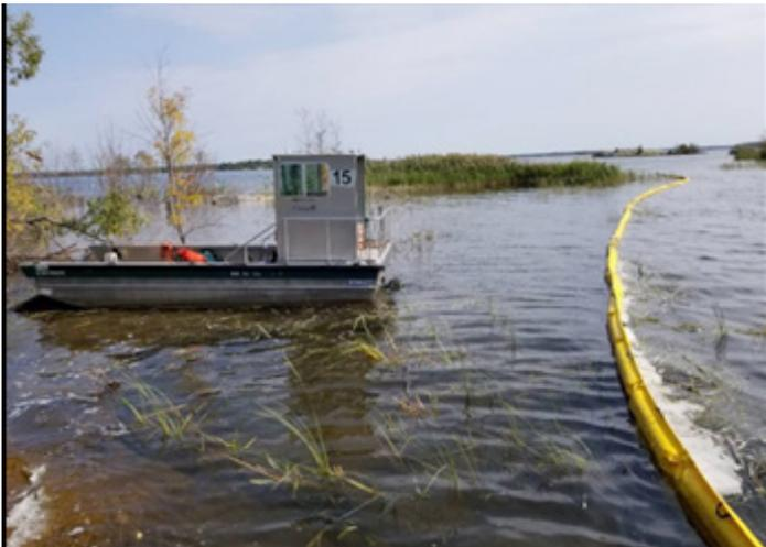
Photo d'une barge utilisée pour transporter la biomasse coupée et le barrage flottant installé pour empêcher la propagation des phragmites pendant l'enlèvement au parc national des Îles-de-la-Baie-Georgienne. Source : Parcs Canada.
