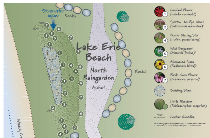
Le plan de conception de Lake Erie Beach, illustrant les caractéristiques qui permettront d'empêcher les sédiments, les bactéries et les nutriments de pénétrer dans les zones de la plage. Source : Ecology & Environment, Inc..
