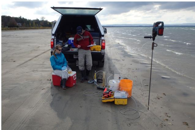
Utilisation d'un système temporaire à pointe filtrante (à droite) afin d'échantillonner les eaux souterraines peu profondes le long du rivage de la baie Georgienne, sur le lac Huron. On a analysé les échantillons afin d'évaluer les éléments nutritifs transportés par les eaux souterraines des systèmes septiques jusqu'à la baie. Source : John Spoelstra, Environnement et Changement climatique Canada.
